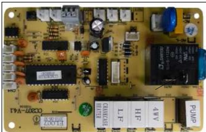
Výstupní fáze L 1 k ovládání cívky stykače filtračního čerpadla
